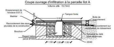
L'ouvrage d'infiltration sous voirie aura un volume utile de 15.13m3.
